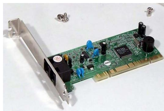
**Modulator /Demodulator** **Modem** والمودم هو اختصار للكلمة **Device** ، ويوجد نوعين من المودم ، حيث يوجد نوع داخلي مثل الكروت ويوضع على اللوحة الأم **Mother Board** ، والنوع الآخر خارجي ، ولكل نوع مميزاته ، راجع الشكل السابق للتوضيح .
